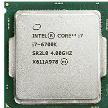
intel core i7 (has 4 cores, 4 GHz)
